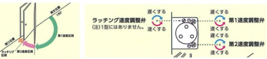
④ドアクローザ内部はピストンとシリンダー構造になっており、本体内に入っている油の流れでスピードを制御しています。調整弁でのスピード調整の構造は以下です。(以下の図は説明用として一部アレンジしています)
